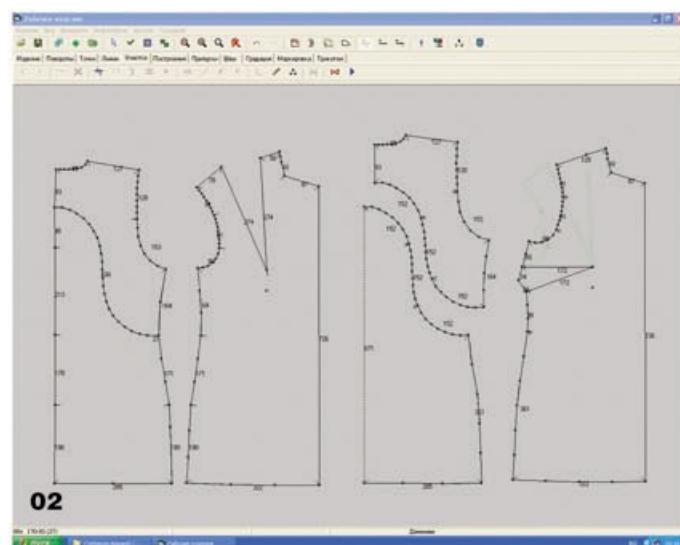
программой раскладки детали из разных тканей распределяются по комплектам. Имеется возможность полного и частичного перевода вытачек, а также веерное раскрытие вытачки, т.е. распределение вытачки частично по нескольким участкам на лекале.
