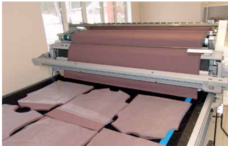
Рис. 2 — Качество настила влияет на качество кроя
