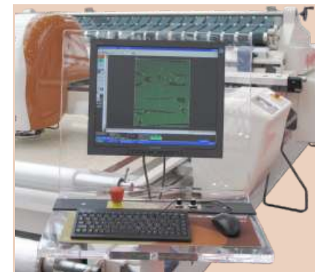
'Cutter Pilot: Make + Cut' - формирование списка раскладок, задание параметров обработки и управление вырезкой
