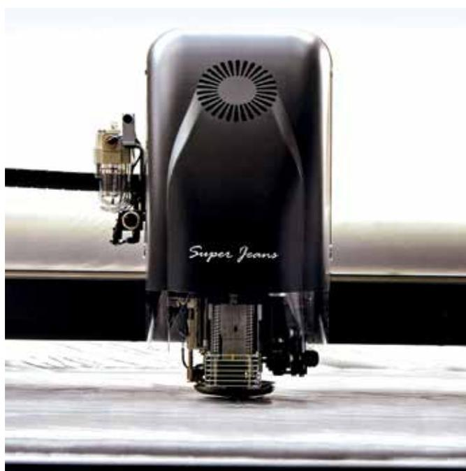
Рис. 3. Усиленная раскройная головка модели Super Jeans
