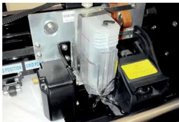
Рис. 11. Система непрерывной подачи чернил (СНПЧ)
