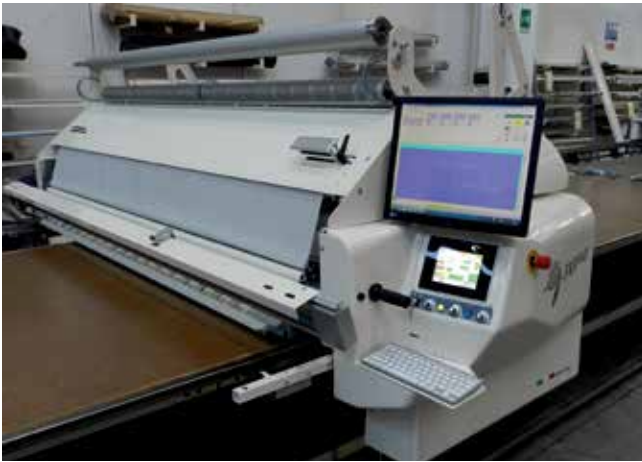
Рис. 14. Настилочная машина нового поколения UNICONT
