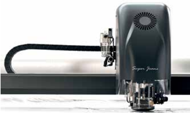
Рис. 15. Усиленная раскройная головка АРУ Super Jeans
