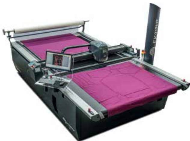
Рис. 11. АРУ для раскроя технического текстиля и композитных материалов Tesno Freccia
