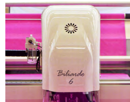
Раскрой настилов с толщиной до 6 см в сжатом виде (модель 60)
